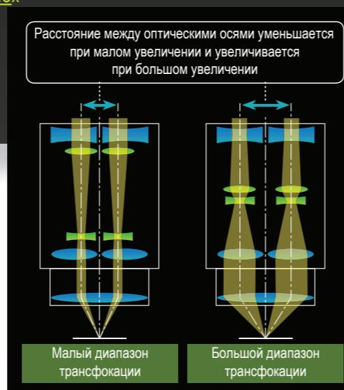
Более высокое значение числовой апертуры для обоих каналов в сочетании с превосходным коэффициентом трансфокации обеспечивает плавный просмотр на макро-и микроуровне.
