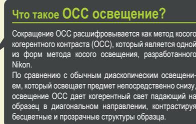
Сокращение OCC расшифровывается как метод косого когерентного контраста (OCC), который является одной из форм метода косого освещения, разработанного Nikon. По сравнению с обычным диаскопическим освещением, который освещает предмет непосредственно снизу, освещение OCC дает когерентный свет падающий на образец в диагональном направлении, контрастируя бесцветные и прозрачные структуры образца.
