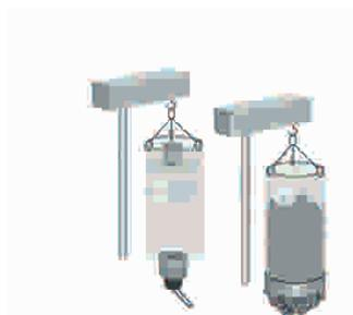
Модуль измерения потребления жидкости, корма и измерение веса тела
