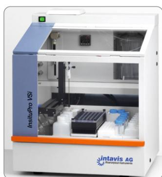
**InsituPro VSi** – станция для автоматизированной гибридизации *in situ* и иммунохимии для анализа цельных проб и тонких срезов на предметных стеклах.
