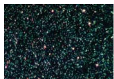
Фотографию любезно предоставил: Ян Лифардт (Jan Liphardt), Калифорнийский Университет Беркли Анализ изгибания высокопараллельных структур ДНК молекулы с использованием микроскопии темного поля. Каждое яркое пятно зеленого цвета – граница плазмона, состоящего из пары золотых связанных ДНК наночастиц. Ферментативное изгибание или распад ДНК можно отслеживать по интенсивности и цвету границ плазмона. Более подробное описание см. в Reinhard et al, PNAS (2007)
