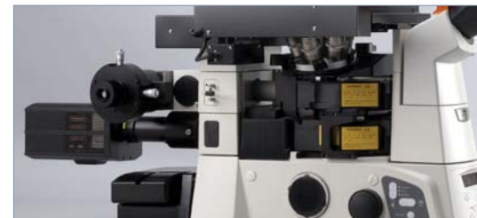
Пример: В дополнение к PFS устанавливается модуль фото-активации (верхний уровень) и задний порт (нижний уровень).
